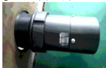
③把测距传感器对准法兰孔
